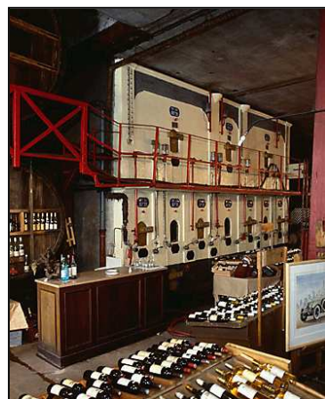
Cuves en ciment de 1925 (à g.) et machine à laver les filtres (à dr.), © Inventaire général, ADAGP , 1997. Photos : Christian Décamps. IA94000462.
